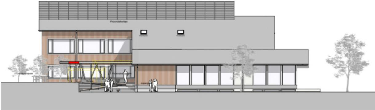
Diese Ansicht von Süden her zeigt die Erweiterung in Richtung Pausenhof. Im oberen Teil des Hauptdaches wird die optimale Ausrichtung für die Erzeugung von Photovoltaik genutzt. Im Vorprojekt ist deshalb auch der Einbau einer 30 kW PV-Anlage geplant. Diese soll direkt in die Dachkonstruktion integriert werden und einen grossen Anteil des eigenen Stromverbrauches abdecken.
